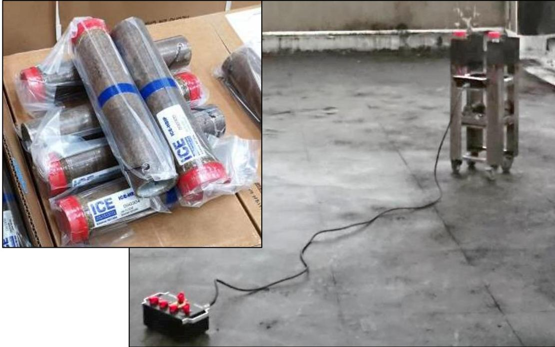
目前國際間常被使用於暖雲環境下增雨作業的焰劑，是美國 ICE 公司的產品(左上圖)，其成分亦適合運用於臺灣附近的大氣環境。臺灣大學人工增雨研發與服務團隊，參考國外設計理念，研製了 ICE 焰劑燃放平台，簡稱增雨器(右上圖)，包含了四管支架、支架端控制盒、主控制盒以及電纜線(連接主控制盒與支架端控制盒)；此增雨器已佈署於全台主要水庫，當增雨條件合適，水庫作業人員就會適時完成安裝，並配合最佳時機燃放焰劑。
