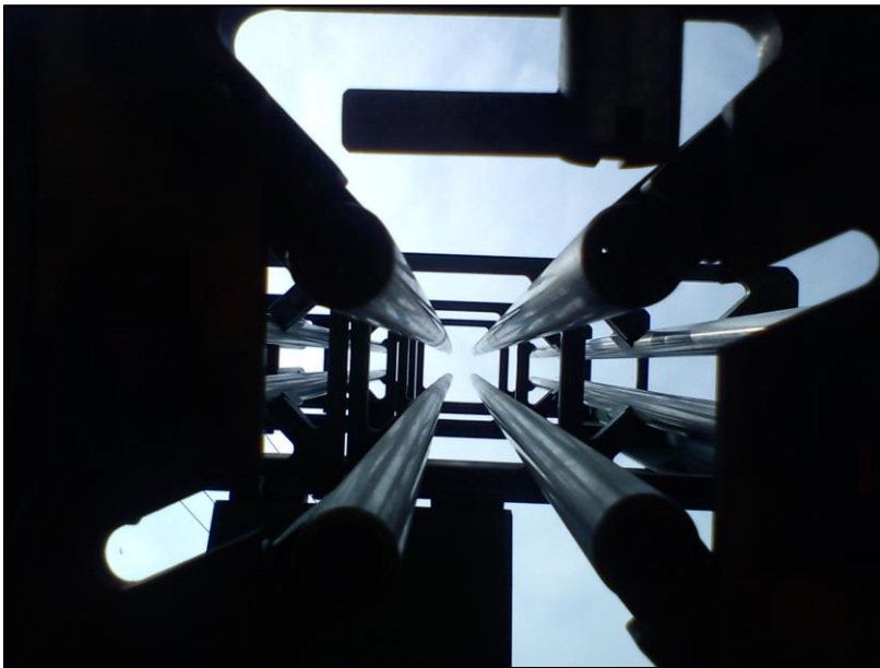
圖2-9-2-4 福建氣象局人工增雨火箭發射車(左)外觀(右)發射管仰視。
